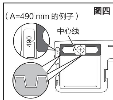
④ 调整本体固定板位置，确保  $B \leq 80 \text{ mm}$ ，再将本体
