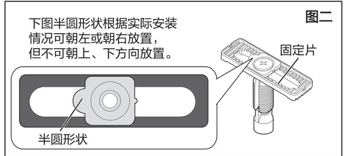
③ 上方施工螺栓在本体固定板上的初步定位。
