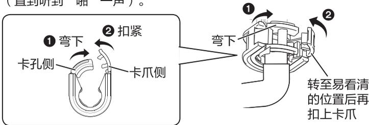
④ 一边握住进水软管, 一边轻轻转动快速卡扣, 确认转动时没有障碍。
